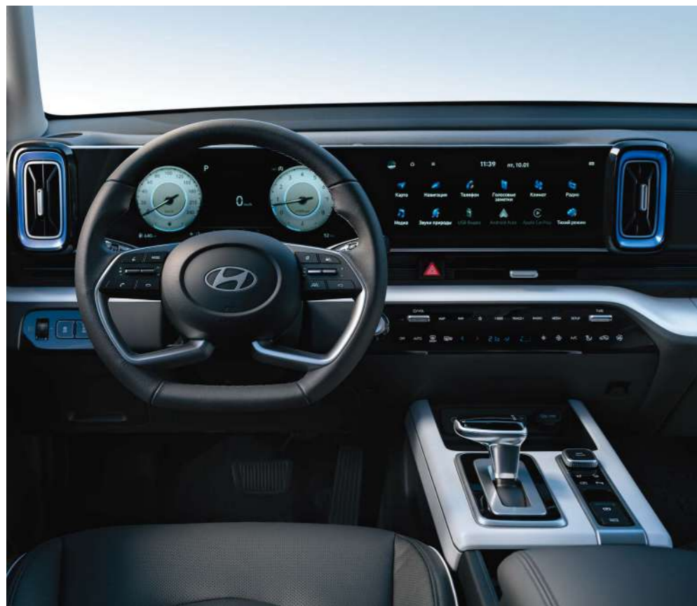
Жүргізу режимдерін таңдау мүмкіндігі бар виртуалды аспаптар тақтасы.
