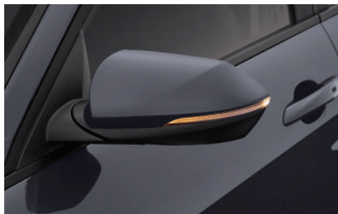
Жылытылатын, жиналмалы және реттелетін электр жетегі және бұрылыс көрсеткіштерінің жарықдиодты қайталағыштары бар сыртқы артқы көрініс айналары
